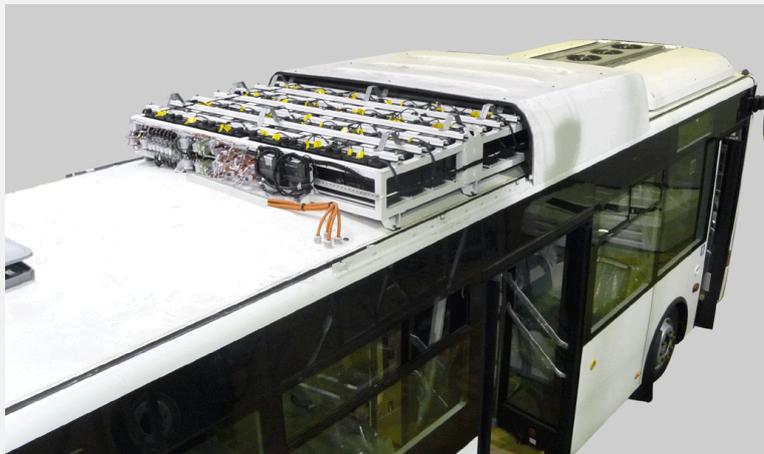
Exemple de batterie installée sur le toit (© photo : [www.sunchainmetal.com](http://www.sunchainmetal.com)), 2019
